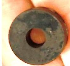
2) Le joint est trop abîmé des deux côtés, remplacez-le par un neuf. **Passer à l'étape 11.**
